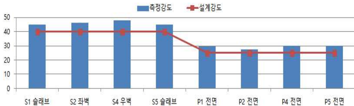
&lt;그림 2.8.20&gt; 비파괴 강도시험 결과분석도
