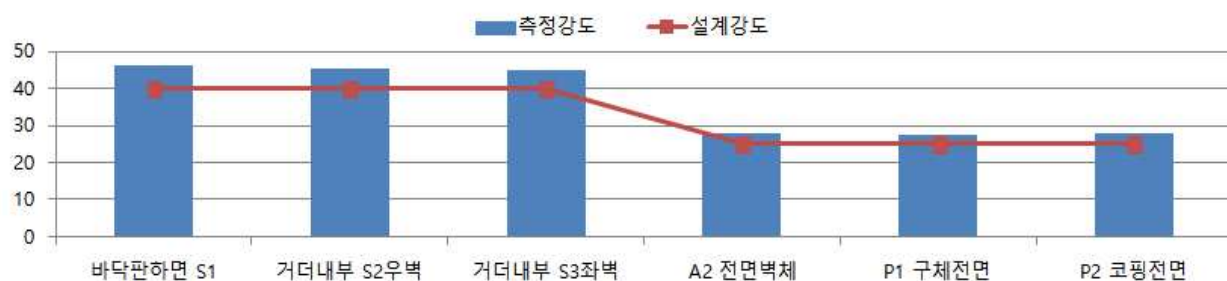
&lt;그림 2.11.20&gt; 비파괴 강도시험 결과분석도
