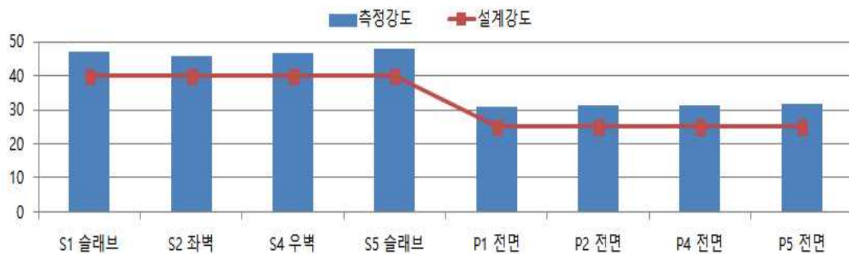
&lt;그림 2.7.20&gt; 비파괴 강도시험 결과분석도
