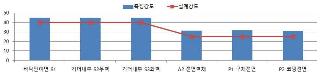
&lt;그림 2.12.20&gt; 비파괴 강도시험 결과분석도
